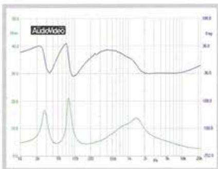
**Зависимость модуля Z от частоты Chario Syntar 516**
