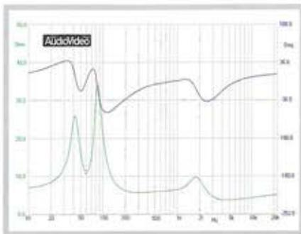
**Зависимость модуля Z от частоты Arslab Emotion 1**
