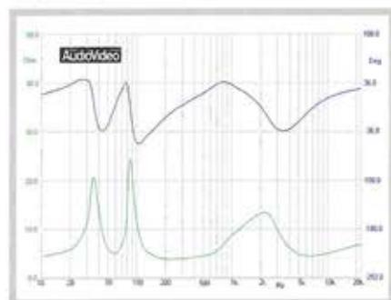
**Зависимость модуля Z от частоты****Boston Acoustics M25**
