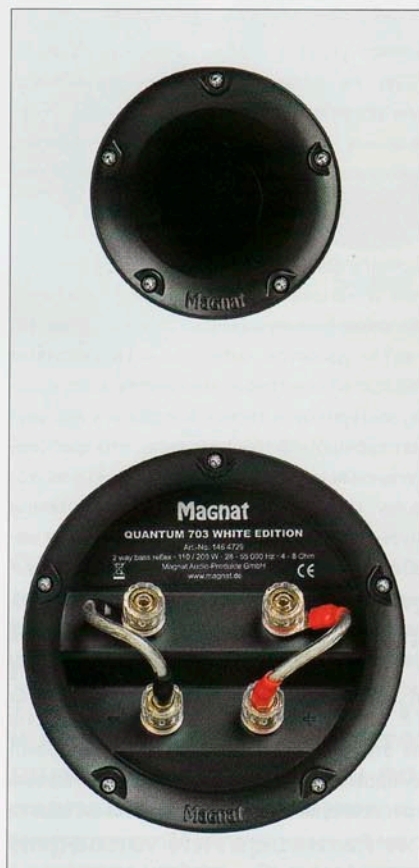
▲ Задняя стенка АС. Вверху — порт фазоинвертора. На фото справа — фрагмент ВЧ-динамика. Звездочка из демпфирующего материала способствует снижению отраженной звуковой волны. Таким способом повышается естественность передачи верхов и ослабляется направленность звучания
