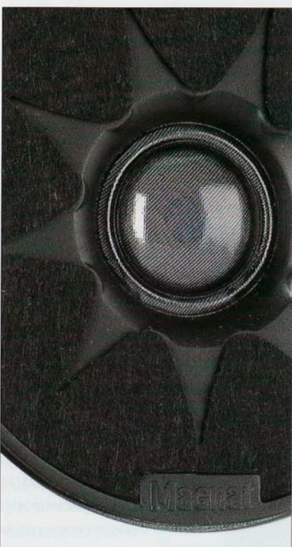
▲ Задняя стенка АС. Вверху — порт фазоинвертора. На фото справа — фрагмент ВЧ-динамика. Звездочка из демпфирующего материала способствует снижению отраженной звуковой волны. Таким способом повышается естественность передачи верхов и ослабляется направленность звучания
